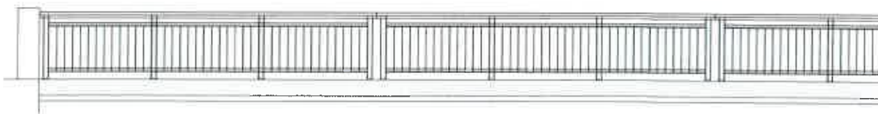
Figura 20 – Alçado parcial do guarda-corpos num dos extremos
