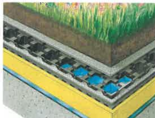
estrutura da cobertura ajardinada
