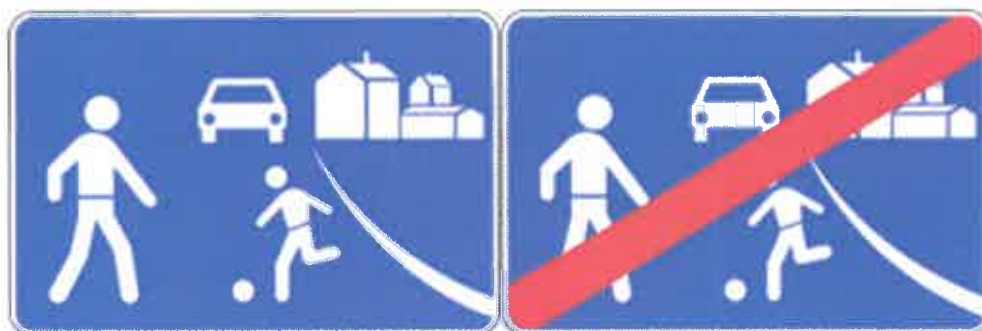
Fig. 87 Sinalização vertical de entrada e saída em zona de coexistência (H46 e H47)
