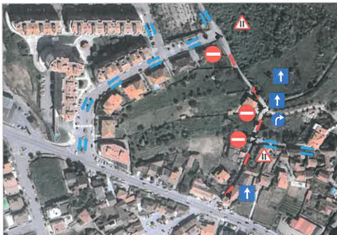
Fig. 9 – Colocação da sinalização vertical proposta.
