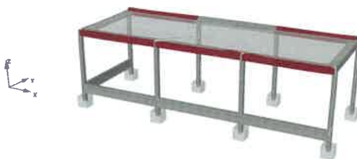
Fig. 8 – Vista 3D do Bloco PD2 – Elementos com capacidade insuficiente ao esforço transverso Ações verticais – MM (Lote A)
